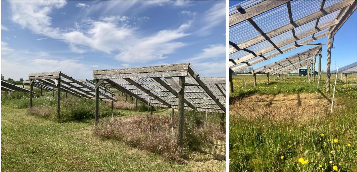
Abb. 1: Aufnahme links: Dachkonstruktionen, die Wasser von den Versuchspartellen ableiten und dadurch den Niederschlag um 55 % reduzieren. Aufnahme rechts: Auswirkungen der experimentellen Trockenheit unter den Dächern auf die Vegetation im Frühjahr 2021.
